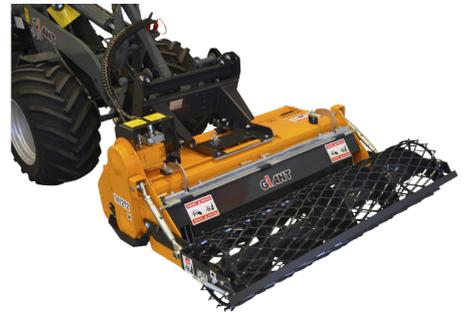
Die Umkehrfräse sind serienmäßig mit einer GIANT-Spannvorrichtung, einem Hydraulikmotor mit Kupplungen und Schläuchen sowie einem vergrößerten Kettenantrieb ausgestattet. Außerdem verfügt dieses Anbaugerät serienmäßig über eine Tiefeneinstellung über die hintere Gitterwalze, 4 „L“-Messer pro Sektion und eine Seitenverschiebung. Die maximale Steingröße beträgt ø7cm. Der notwendige Anschluss für den Grubber ist 1x doppelwirkende Hydraulikfunktion, 1x Arretierung, 1x freier Rücklauf und 1x Lecköl.
