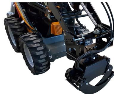
Diese Holzspanner kompakt sind serienmäßig mit mechanischer Drehvorrichtung und ohne Spannvorrichtung ausgestattet. Der notwendige Anschluss dieses Anbaugerätes ist 1x DW Hydraulikfunktion.
