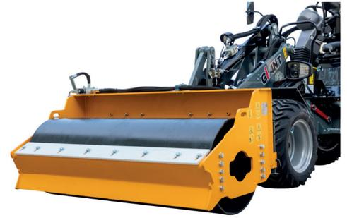
Diese hydraulische Walze ist serienmäßig mit einem maximalen Öldruck von 250 bar ausgestattet. Die notwendigen Anschlüsse für dieses Anbaugerät bestehen aus 1x doppelwirkende Hydraulikfunktion, 1x Arretierung, 1x freier Rücklauf und 1x Lecköl.
