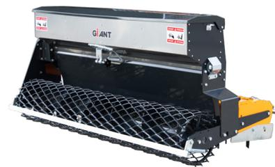
Diese Kreiselegge ist serienmäßig mit einer Anbauplatte, einem Hydraulikmotor mit Kupplungen und Schläuchen, einer Überdruckschutz im Hydrauliksystem, einem starken Zahnradantrieb, einer Tiefeneinstellung über Seitenplatten und einer Seitenverschiebung ausgestattet. Die notwendigen Anschlüsse dieses Anbaugerätes sind 1x DW Hydraulikfunktion, Arretierung, freier Rücklauf und Leckölanschluss.
