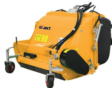
Diese Schlegelmulcher mit Behälter sind serienmäßig mit Bechermesseraus 3 mm Stahl ausgestattet. Die notwendigen Anschlüsse des Schlegelmulchers erfordern 2x doppelwirkende Hydraulikfunktionen, 1x Arretierung, 1x freier Rücklauf und 1x Lecköl.
