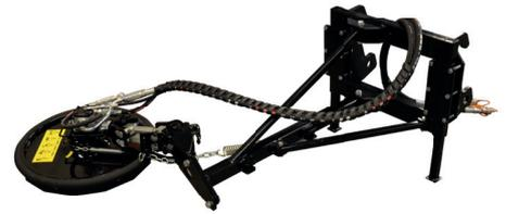
Die notwendigen Anschlüsse des Stabmähers erfordern 1x doppelwirkende Hydraulikfunktion, 1x Arretierung, 1x freier Rücklauf und 1x Lecköl.
