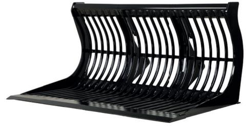
Diese (Straßen-)Zerkleinerungsschaufeln sind serienmäßig mit einem breiten Hardox- Messer und einem langen Absatz ausgestattet, wobei die Stangen vor dem Rahmen verlaufen. Die Schaufel ist speziell für das Ausfräsen von Straßenarbeiten konzipiert.
