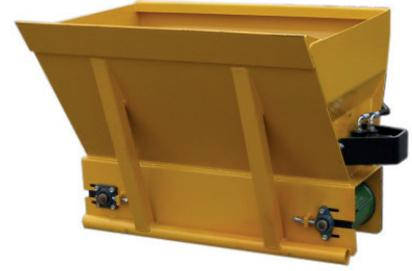
Diese Sandverteilerschaufel sind standardmäßig oben mit einer Mischer oben ausgestattet, das Anbaugerät ist links und rechts entladbar und hat Dosierschieber über dem Transportband. Die notwendigen Anschlüsse für dieses Anbaugerät erfordern 1x doppelwirkende Hydraulikfunktion.
