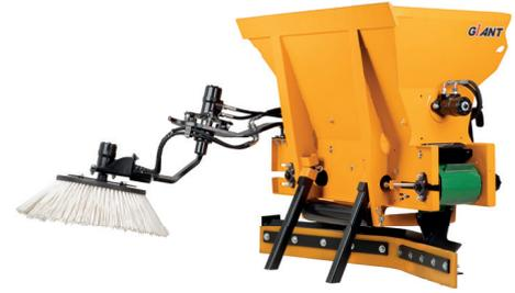
Diese Verteilerschaufel ZV sind serienmäßig mit Rührschnecke oben, Entlade- und Dosierplatten links und rechts über dem Förderband ausgestattet. Der notwendige Anschluss für diesen Aufsatz erfordert 1x doppelwirkende Hydraulikfunktion.
