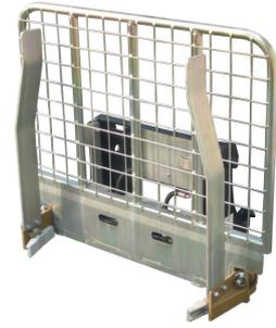
Der notwendige Anschluss für dieses Anbaugerät erfordert 1x doppelwirkende Hydraulikfunktion. Bei Verwendung dieses Anbaugerätes auf einem Skid ist ein Gegengewicht erforderlich.
